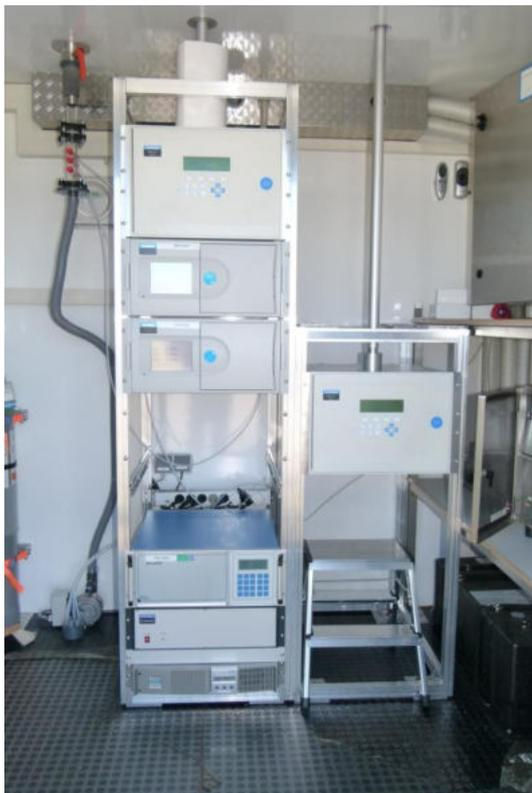
Abbildung 4. Innenausstattung der mobilen Luftgütemessstation.
